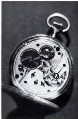
7 Damentaschenuhr in gullochiertem Schweizer Silbergehäuse, Mond mit Krone, 16 steiniges Ankerwerk mit Nickel-Unruh, 16 Gewichts- und 2 Regulatorschrauben, Breguetspirale und verschraubten, versenkten Bronze-Chatons Email-Zifferblatt (vorgetäuschte Dreiteiligkeit)
