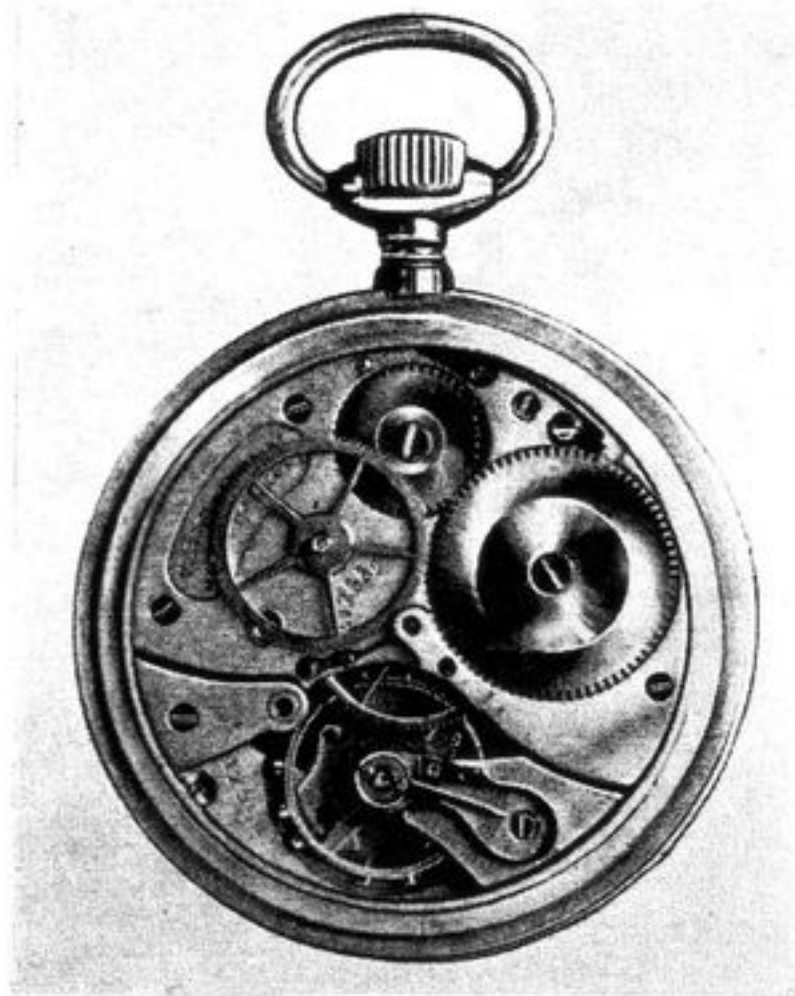
Bild 17 Beobachtungsuhr mit zentraler Sekunde indirekt angetrieben
