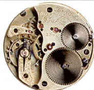
Abb. 29 und 30: Taschenuhr J. Alßmann auf der hinteren Platinenplatte: Uhrenfabrikation. J.A. N° 2546 Glashütte. 1/2 Platinen, Kronenaufzug, auf der Zifferblatt-Seite Werkpunzierung J.A. und die Nummer, Herstellungsdatum XII. 1860
