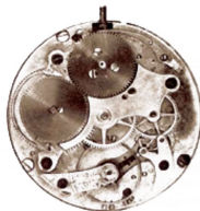
Abb. 41: Aus Huber (13): Eine frühe Lange Uhr N° 1253 mit frühem Kronenaufzug
