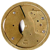
Abb. 22: Zifferblattseite mit Punzierung. Federhausbrücke links (3.2) und Brücke der Hemmungsteile rechts (2.2.3)
