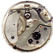
Abb. 32: ALS 6509: Zifferblattseite mit Punzierung G&L und Seriennummer. Die Rückholfeder der Kronenzeigerstellung zeigt hier noch die Frühform mit angeschraubtem Hebel und Feder
