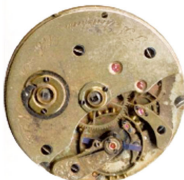
Abb. 27: 2/3 Platinenwerk von Julius Abmann mit Punze: J.A. 2088, Typ Va unserer Einteilung
