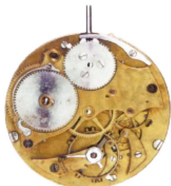
Abb. 40: Abmann N° 1873. Früher Kronenaufzug aus der fast gleichen Entwicklungsstufe wie die Lange-Uhr in Abb. 41
