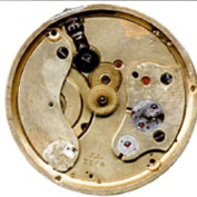
Abb. 29 und 30: Taschenuhr J. Alßmann auf der hinteren Platinenplatte: Uhrenfabrikation. J.A. N° 2546 Glashütte. 1/2 Platinen, Kronenaufzug, auf der Zifferblatt-Seite Werkpunzierung J.A. und die Nummer, Herstellungsdatum XII. 1860
