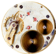
Abb. 31: ALS 6506 W: Glashütter Taschenuhr N° 6506 mit 1/2 Platinen endgültiger Art. Aufzugsräder strohgelb angelassen (noch vor dem Sonnenschiff). Verkauf 1869 nach New York
