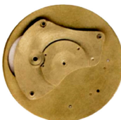
Abb. 21: Typ II, N° 713 (I. 1853) von L&G. Obere Platine abgerundete Form des 2. Typs Ziffercode 1.2.2
