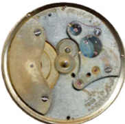
Abb. 28: Typ Va (V.1859) FGU II 29 Typ So J.A. N° 2088 gleiches Werk, Zifferblatseite mit Blick auf die Werkplatte und Punzierung
