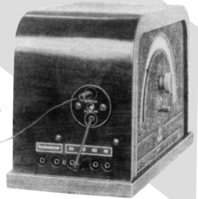
Der Sperrkreis ist eingebaut — und schon angeschlossen.
