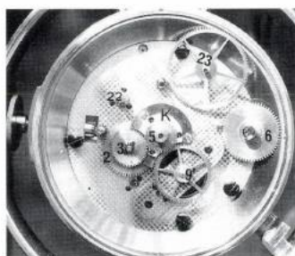
8c Abnahme des 1. Gradzeigerrades [6] und des Auf- und Ab-Zeigerrades [22]. Gut sichtbar ist der Eingriff des 2. Gradzeigerrades [5] zum oberen Wechselrad [3].
