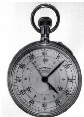
11 a Marine-Gradmaß-B-Uhr ALS Nr. 95405 zeigt äußerlich die gleiche Ausführung wie in Abb. 12a. Sie besitzt 180°-Zifferblatt, 2 Gradzeiger und 1 Bogenminutenzeiger. Die Uhr zeigt 67°54".
