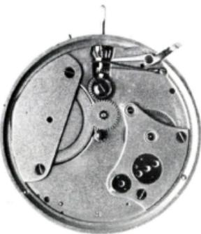
4 Dreiviertel-Platine der bekanntesten Adolf-Lange & Söhne-Ausführung mit dem auf der Platine integrierten Ankerradkloben und der Werk-Nr. 27465.
