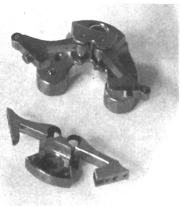
Abb. 12. Der Goerß-Anker: oben zweiteilig nebeneinander gelagert; unten: federnd von einem Stück gearbeitet
