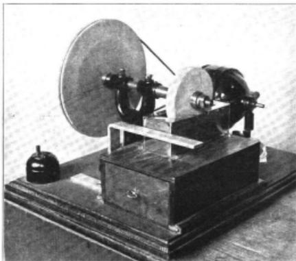
Abb. 3. Maschine zum Gläser schleifen
