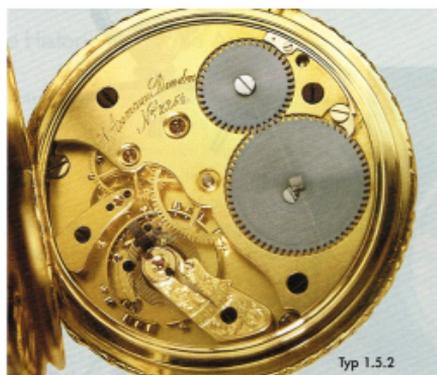
Jahr 1859 gefertigt worden sein. Unterschiede finden sich z.B. bei der Formgebung der 2/3 Platine, den Kloben, der feinen Vollendung des Unruhklöbels sowie dem Material und der Verschraubung des Stahlplättchens bzw. der Rosette des Unruhdecksteins. Die abgeflachten Enden der 2/3 und später bei der 3/4 Platine bilden bei Werken der Firma Assmann bis etwa zur Werknummer 11.000 ein Alleinstellungsmerkmal.
