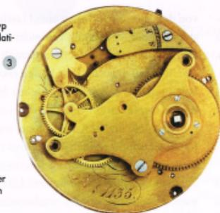
Beispiel eines Ausgangs der 1850er Jahre verwendeten Stahl-Messing-Ankers.
