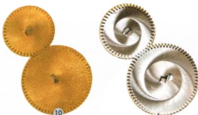
10 Frühes Kronenaufzugwerk, Werknummer 2254, Typ 1.5.2 mit Stahlaufzugsrädern nach ohne Glashütter Sonnenschliff. Daneben Aufzugsräder aus Sterrometall und aus Stahl mit Sonnenschliff.
