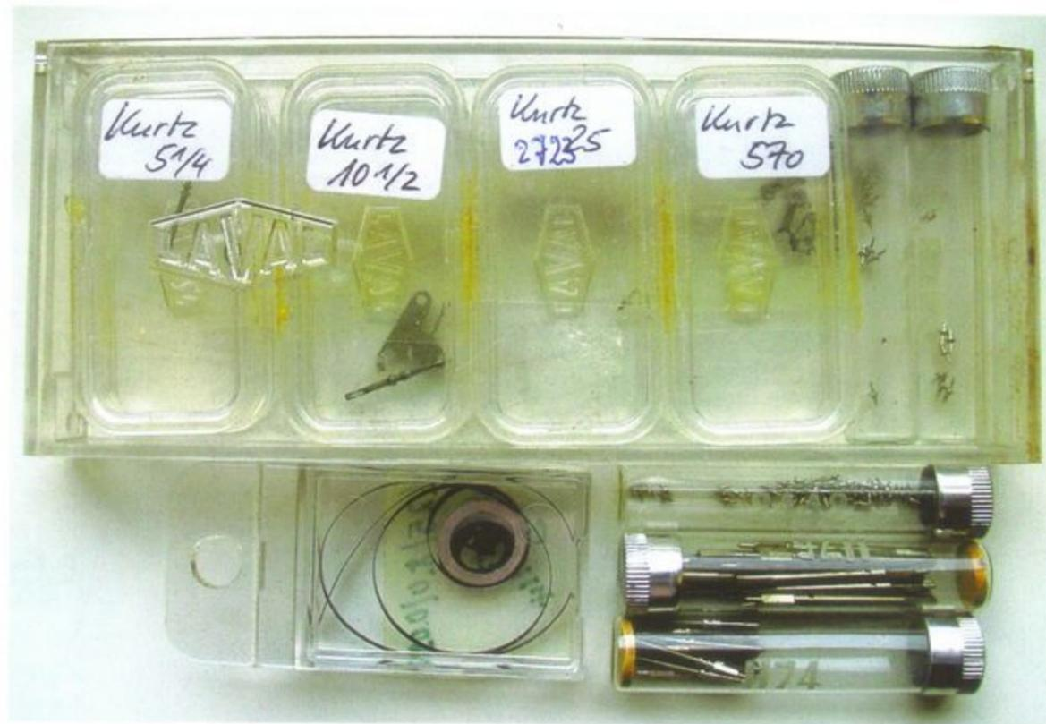
Abb. 4: Furnituren (Unruh-, Aufzugswellen, Federn, Hebel usw. der Cal. 5 $\frac{1}{4}$ , 10 $\frac{1}{2}$ , 25 und 570)
