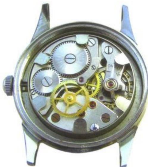
Abb. 11: Cal. 25, Werkansicht, gepresste Goldchatons, Schraubenunruhe, Stoßsicherung, Preis 93 DM
