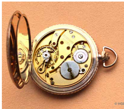
Abb. 10 Werkansicht der 16-steinigen Werkausführung
