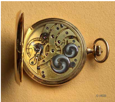
Abb. 7 Werkseite der 20-steinigen Savonette mit dem Rohwerk der Schweizer Firma Emil Judith aus Biel
