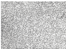
Abb. 1. Schliffbild einer Beryllium-Kupfer-Legierung mit 2,5% Beryllium, mit Ammonium-Kupferchlorid geätzt
