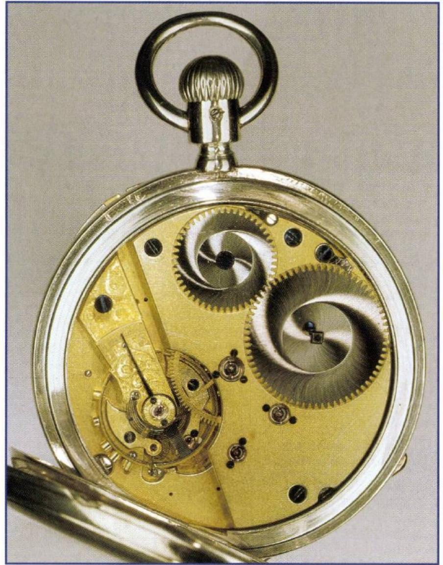
Abb. 67b: Schon der erste Blick auf das Werk verrät die Spiegelbildanordnung: grosses Aufzugsrad rechts der Mitte. In hängender Lage Unruhkloben mit dem Fuss und der Verschraubung nach oben
