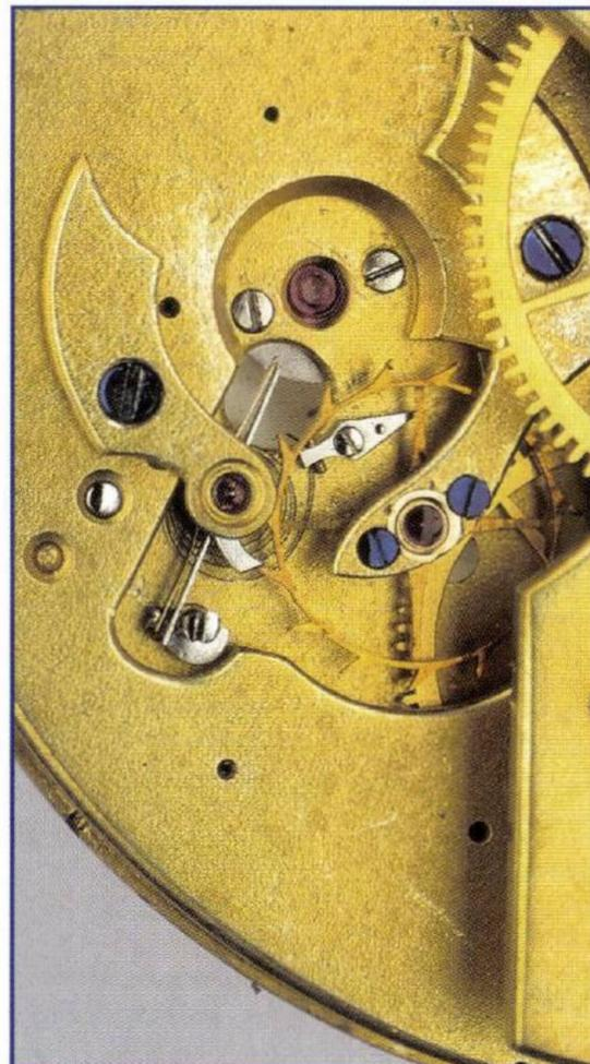
Abb. 67c: Aus dem aus dem Gehäuse genommenen Werk kann man gut die Grössenverhältnisse der Platinen zueinander erkennen und messen. Der gerade, kreissegmentartige Abschnitt der oberen Platine ist typisch bei den Großmann'schen Taschenchronometern, der sich auch später in den grossen Lange'schen Taschenchronometern wiederfindet
