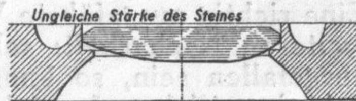
Abb. 15. Der Stein wird nach dem Verdrücken schief liegen
