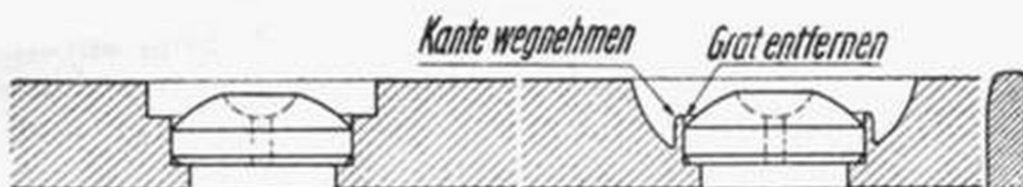
Abb. 11. Abb. 12. Glashütter Fassung; links: Drehen der Stufe, rechts: Drehen des Stiches
