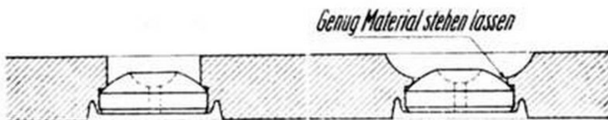
Abb. 17. Schweizer Fassung Abdrehen des Stiches Abb. 18. Aufdecken des Steines
