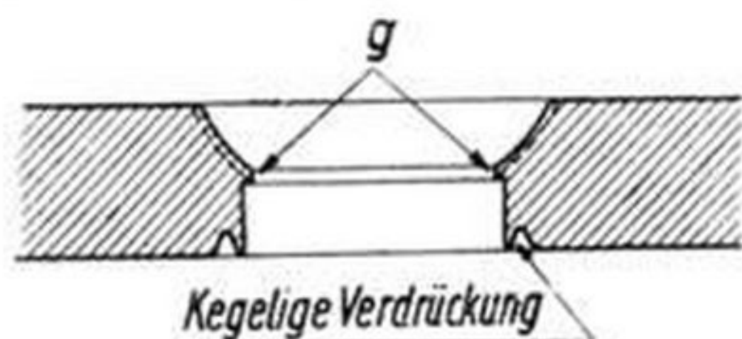
Abb. 52. Stahlfassung. Drehen der Fassung vor dem Härten
