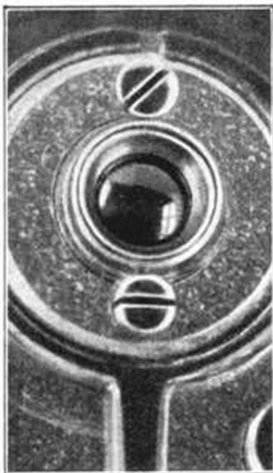
Abb. 47. Goldfutter für den Deckstein einer Glashütter Uhr
