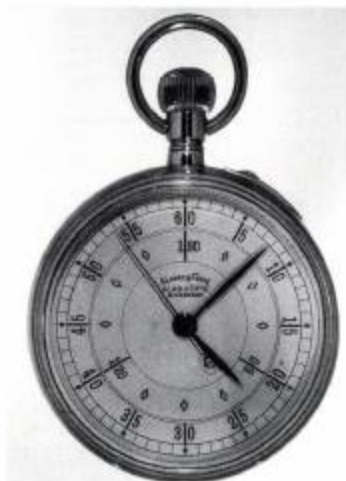
11 a Marine-Gradmaß-B-Uhr ALS Nr. 95405 zeigt äußerlich die gleiche Ausführung wie in Abb. 12a. Sie besitzt 180°-Zifferblatt, 2 Gradzeiger und 1 Bogenminutenzeiger. Die Uhr zeigt 67°54".
