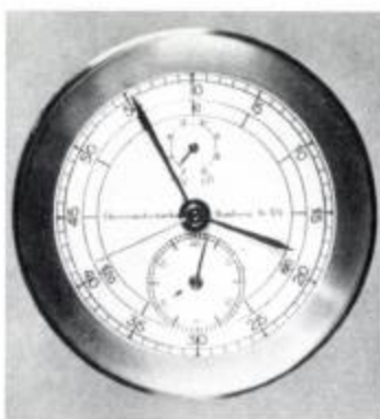
10 Gradmaß-Marine-Chronometer der Chronometerwerke Hamburg, geprüft auf der Seewarte am 5.5.1936 (Abb. aus Ann. Hydrogr. (21).)
