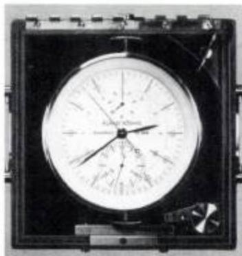
7 Gradmaß-Marine-Chronometer von ALS Nr. 698, geprüft auf der Seewarte am 4.3.1936 (Abb. aus Ann. Hydrog. (21).)
