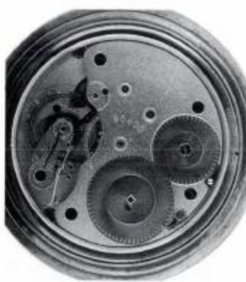
11 b Werk von 95405 entspricht dem Kaliber 43 der Deutschen Uhrenfabrikation Glashütte und unterscheidet sich nicht vom Werk der 95403.
