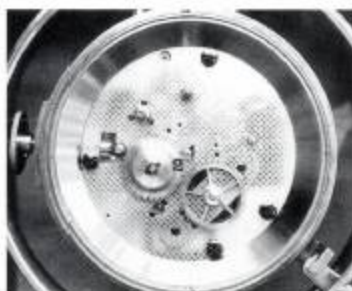
8d Weitere Abnahme des 2. Gradzeigerrades [5] und 1. Bogenminutenrades [10] mit Kloben [K]. Gut sichtbar der Eingriff vom Minutentrieb [1] in das untere Wechselrad [2].
