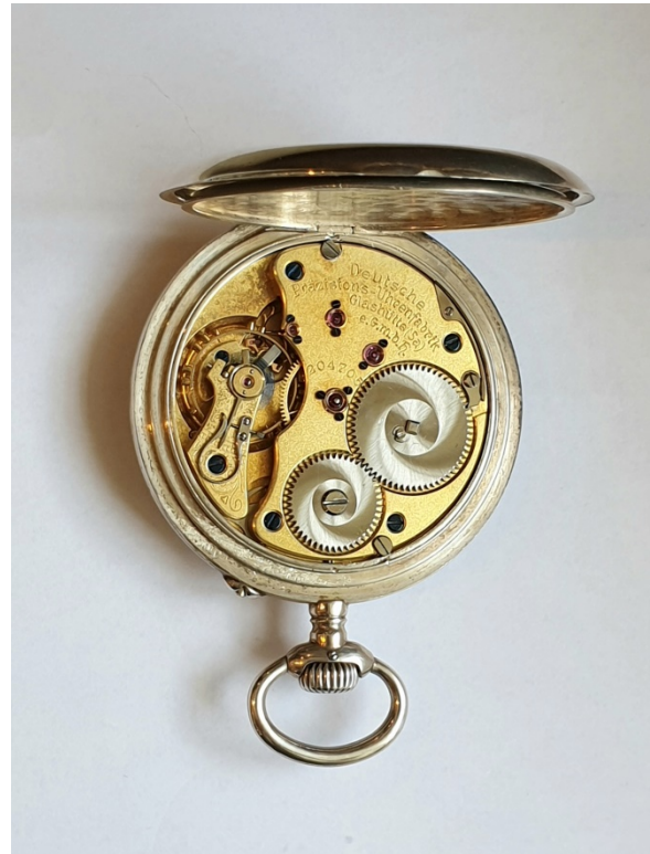
Bild 7: 16-steiniges Glashütter Präzisionswerk der DPUG für „Centra“ Uhren. Kaliber 43 Typ 2.1
