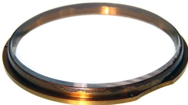
Der Glasrand wurde aus Messing gedreht. Die gewölbte Glasscheibe ist mit einer Fasse versehen und durch Umbördeln des Randes gefasst.
