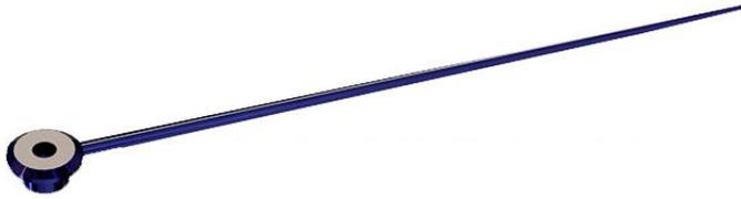
Der Zeiger besteht aus Stahl. An der Spitze ist er kaum stärker als ein Haar. Um einen guten Kontrast zum Zifferblatt zu erzielen, wurde er durch Erwärmung auf ca. 290°C blau angelassen. Auf der Stahl-
