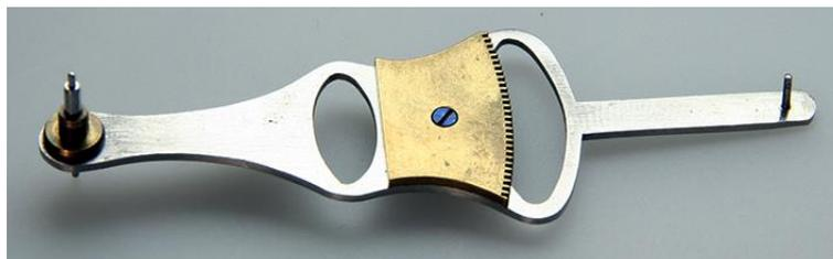
Um die geringe Drehung der Schwinge zu verstärken, wurde ein zweistufiges Rädergetriebe vorgesehen.
