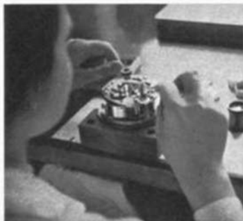
Für die Große Fahrt ist auch dieses Schiffschronometer vorgesehen. Im Glashütter Uhrenbetrieb, in der Abteilung Chronometrie, entstehen die empfindlichen Geräte, die unsere Flotte und Schiffe anderer Nationen an Zeit und Ort gemahnen
