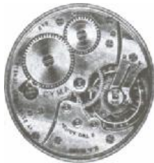
Abb. 1 Mit Steinfutter versehene Taschenuhrwerke
