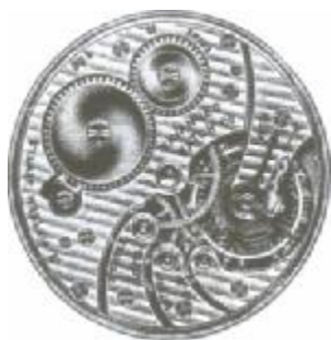
Abb. 1 Mit Steinfutter versehene Taschenuhrwerke
