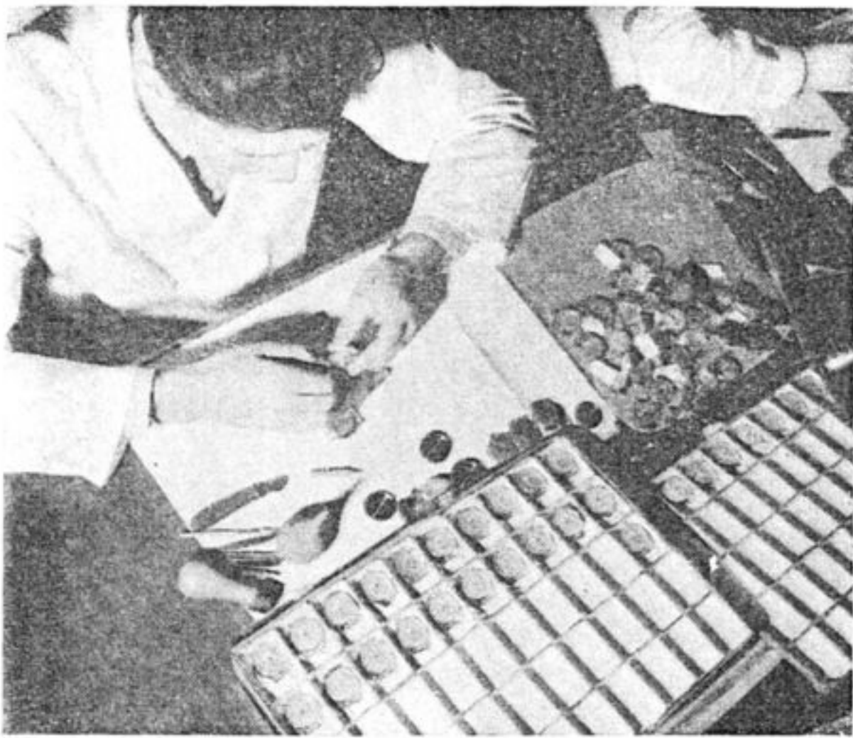
Bild 5. Sichtkontrolle des Uhrwerkes vor dem Verschließen des Gehäuses
