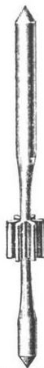
Abb. 18. Stahl- trieb mit 6 Zähnen.
