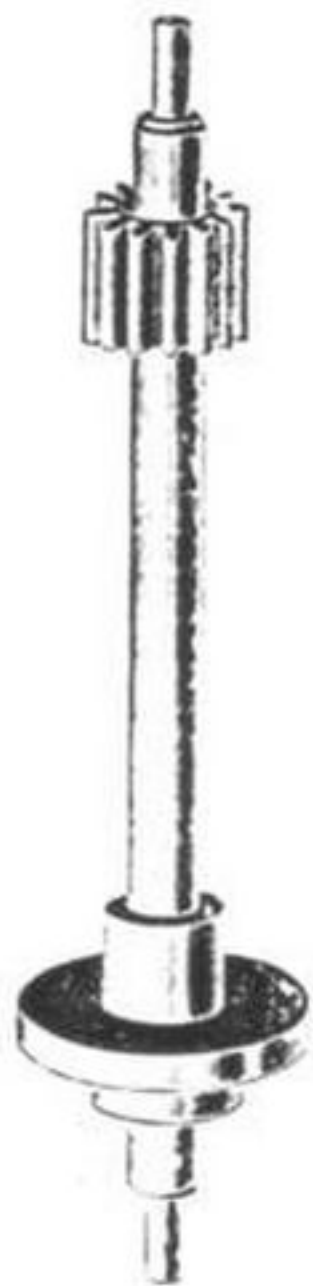
Abb. 23. Volltrieb aus Stahl mit 12 Zähnen.
