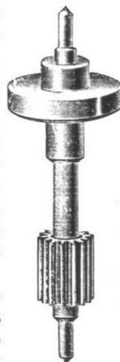
Abb. 19. Volltrieb mit 14 Zähnen.
