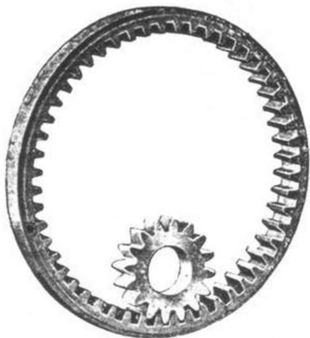
Abb. 26. Eingriff eines Rades mit Innenverzahnung auf ein Planetenrad.
