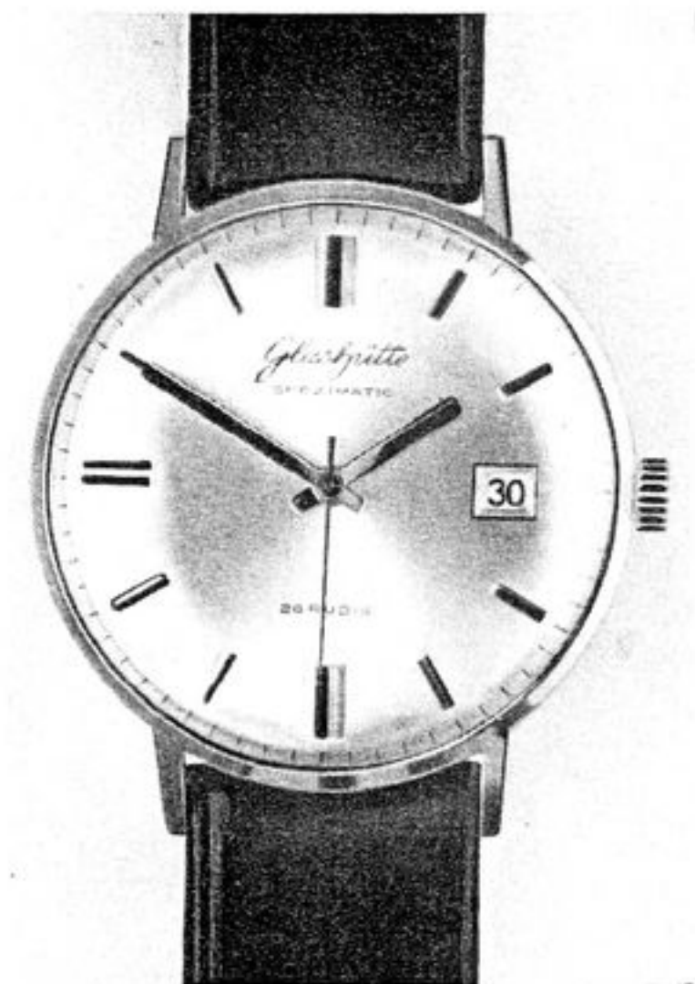
Bild 10 Kaliber 75, Spezimatic Herrenarmbanduhr mit zentraler Sekunde und automatischem Aufzug und Datumanzeige, extra flache Bauart, stoßgesichert Werkdurchmesser: 28 mm 26 Steine Palettenankerhemmung flache Nivaroxspirale Produktionszeit: 1964—z. Z. Gütezeichen Q
