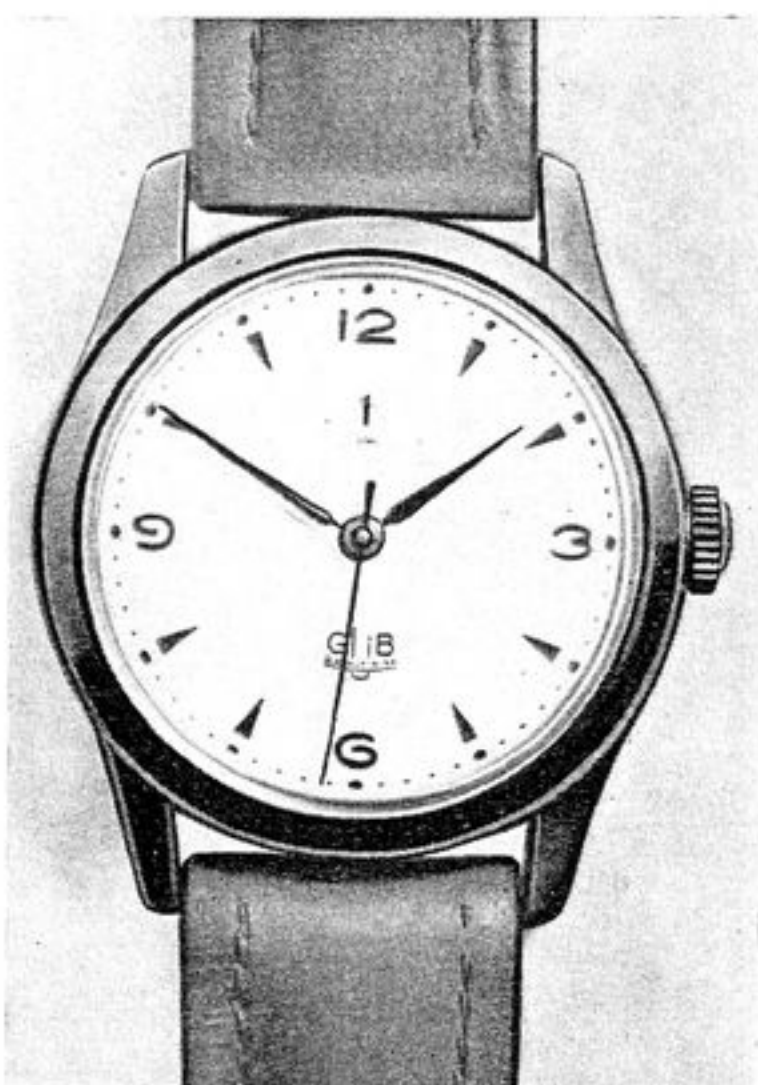
Bild 5 Kaliber 28.3, Herrenarmbanduhr mit zentraler Sekunde Werkdurchmesser: 28 mm 15 Steine Palettenankerhemmung flache Nivaroxspiralfeder mit Feineinstellung Produktionszeit: 1948–1954 Gütezeichen Q
