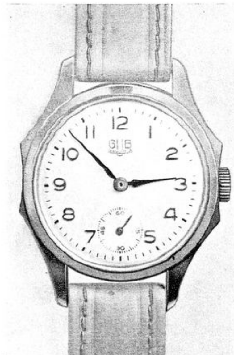
Bild 4 Kaliber 28.2, Herrenarmbanduhr mit exzentrischer Sekunde Werkdurchmesser: 28 mm 15 Steine Palettenankerhemmung flache Nivaroxspirale mit Feineinstellung Produktionszeit: 1948–1954 Gütezeichen Q
