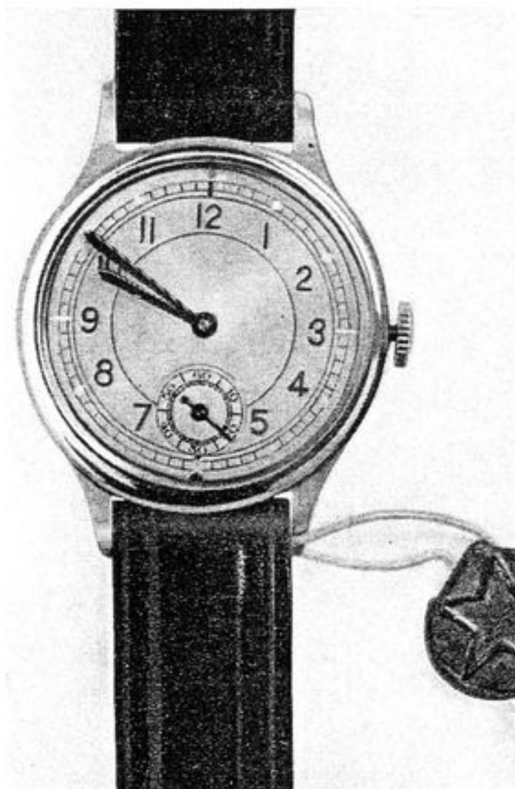
Bild 3 Kaliber 612, Herrenarmbanduhr mit exzentrischer Sekunde Werkdurchmesser: 28 mm 15 Steine Palettenankerhemmung flache Nivaroxspirale Produktionszeit: 1947—1953 Gütezeichen 1
