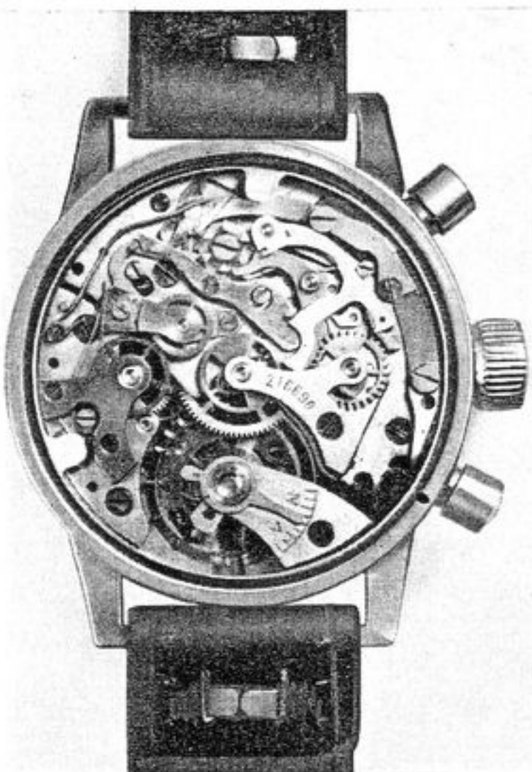
Bild 2 Kaliber 59, Armbanduhrstopper mit zentraler Sekunde, stoßgesichert Werkdurchmesser: 34 mm 17 Steine Palettenankerhemmung Brequet-Spirale Besonderheiten: mit Additions-Stoppeinrichtung und Minutenzähleinrichtung, Präzisionsmontage Produktionszeit 1940—1945 Fabrikat „Urofa“
