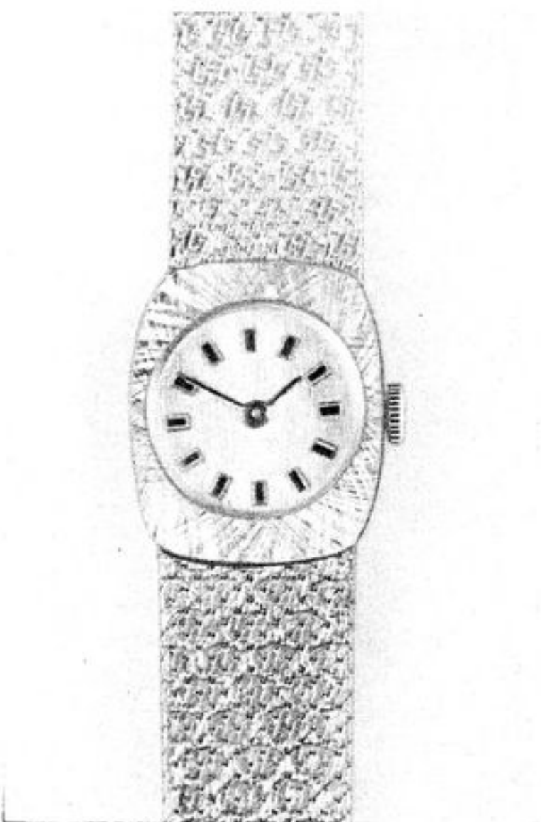
Bild 11 Kaliber 08-20, Damenarmbanduhr ohne Sekunde, stoßgesichert Formwerk 13 × 15,15 mm 17 Steine Palettenankerhemmung flache Nivaroxspirale Produktionszeit: 1969—z. Z. Gütezeichen 1
