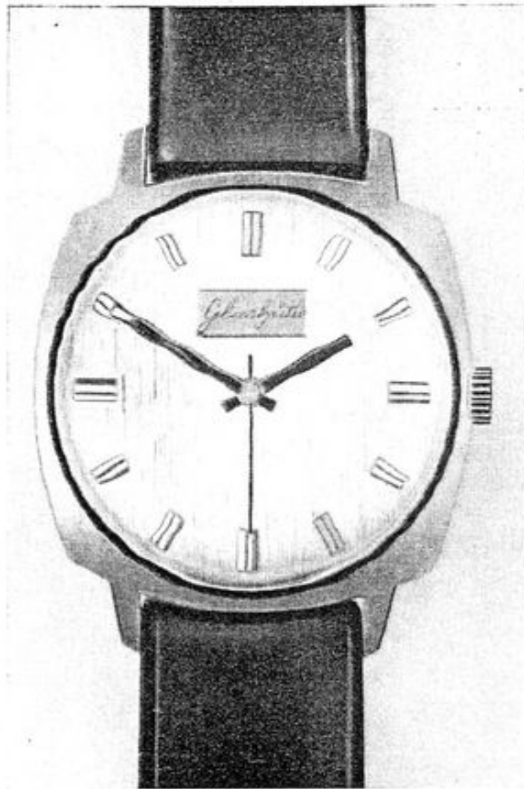
Bild 9 Kaliber 74, Spezimatic Herrenarmbanduhr mit zentraler Sekunde und automatischem Aufzug, extra flache Bauart, stoßgesichert Werkdurchmesser: 28 mm 26 Steine Palettenankerhemmung flache Nivaroxspirale Produktionszeit: 1964—z. Z. Gütezeichen Q
